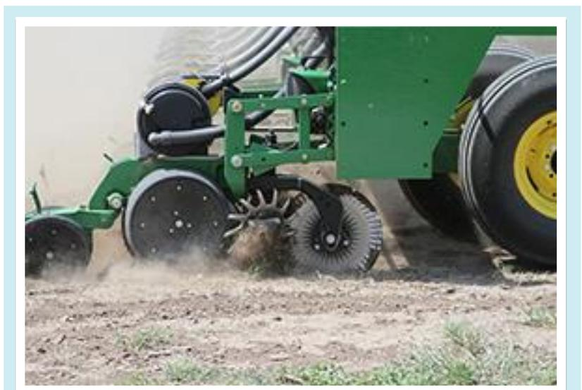
圃場全域にわたって、一度通過する間に畝を立て、畝から作物残滓を除去し、種を播き、土をかける作業を行うこの不耕起すなわち無耕起用播種機によって、土壌侵食が最小限に抑えられ、農作業効率が高まる。
