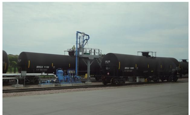
写真6 Siouxland Ethanol社輸出用バイオエタノール貨車タンク積込様子
