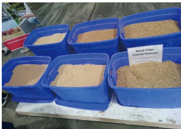
写真6 粉碎されたコーンストーバー(奥)とウッドチップ(手前)。それぞれ左から右に粒径100マイクロ(0.1ミリメートル)、8分の1インチ(3.2ミリメートル)、4分の1インチ(6.4ミリメートル)に粉碎したもの。
