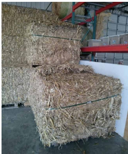
写真5 バイオマス原料として用いるコーンストーバーのバイル
