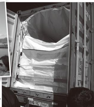
IPハンドリングに最適なコンテナ用トランスバグの例
