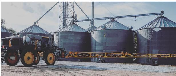
写真10 除草剤散布を行うスプレーヤー 写真右側のトラクター部分から左右にアームが伸びていて、そこから薬剤を散布する。トラクター部分はトウモロコシが生育しても傷つけずに農地に入れるように高くなっている。
