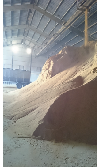
製造過程からコンベヤで送られてきたDDGSが天井から倉庫に保管される
