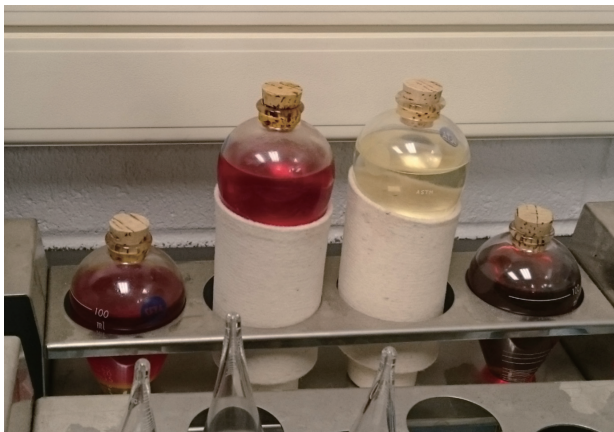
図12 アドキンス・エネルギー社の粗トウモロコシ油と脂肪酸メチルエステル
