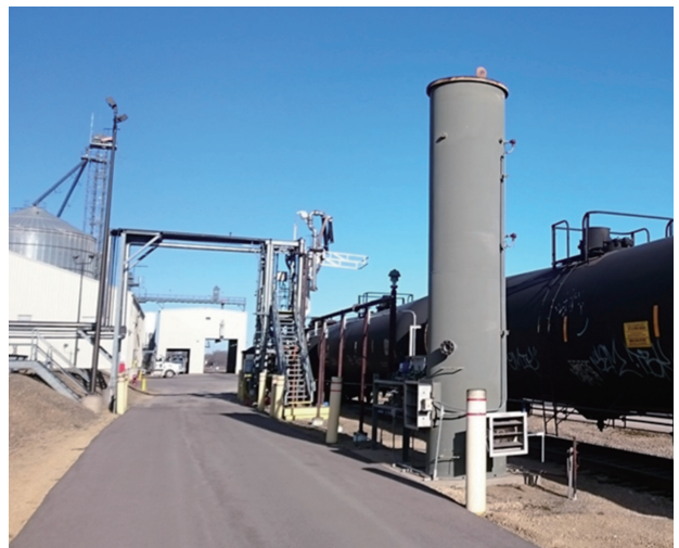
左の貯蔵タンクからパイプによって右の線路に止まっているタンク車にエタノールを移す
