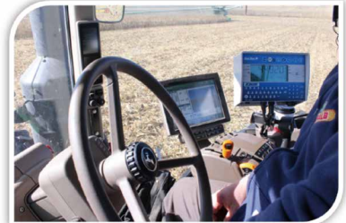
写真6 コンピューターが搭載されGPSでデータ収集や制御を行うコンバインの Cockpit
