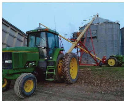
写真15 穀物保管庫の上部に設置されている乾燥機へのオーガーでのトウモロコシ搬入
