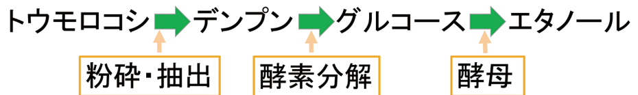
図8 トウモロコシ由来エタノール生産の工程
