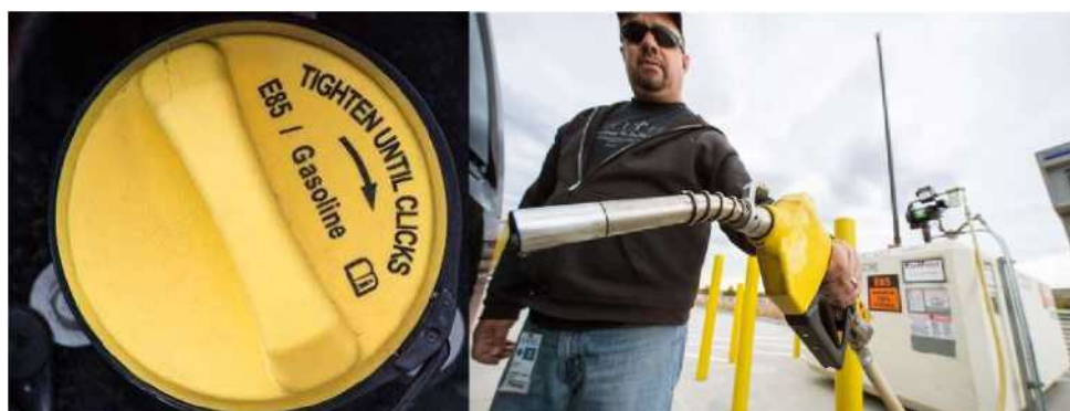
図4 FFVの黄色燃料タンク・キャップとそれに合う給油機のノズル
