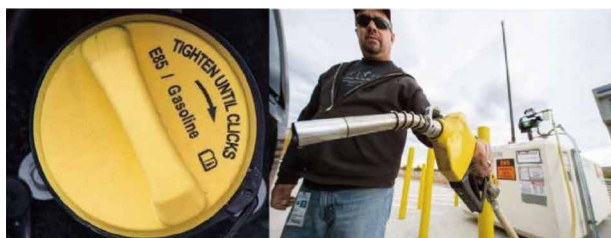
図4 FFVの黄色燃料タンク・キャップとそれに合う給油機のノズル 出典:国立再生可能エネルギー研究所 32163および32153
